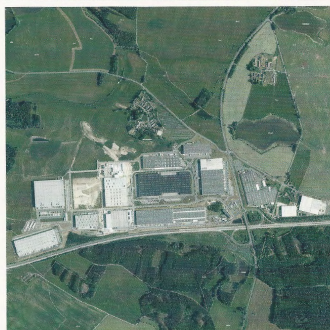
2a, b Ortofoto z roku 2005 s první postavenou halou o ploše 17 000 m 2 , částečně určenou k výrobě, částečně ke skladování (a); ortofoto z roku 2019 s téměř dokončenou strukturou logistického centra, dnes CT Park Bor (b); zdroj: Geoportál ČZÚK.
